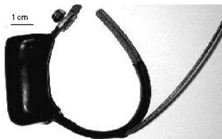
Photo. 5 : Le collier émetteur MI-2 de chez Holohil System Ltd a une durée de vie de 36 mois ne pèse que 32g.
