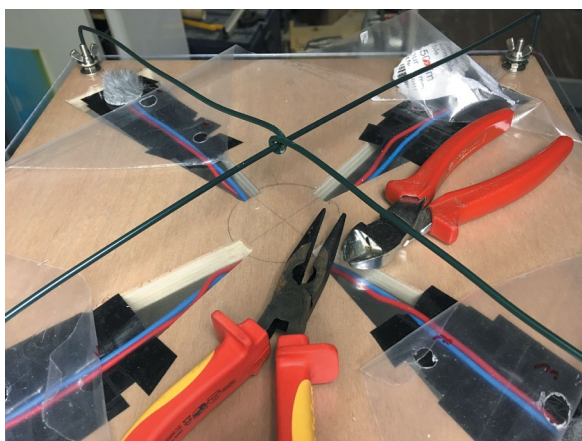
Photo 2 : Tête plate de l'unité autonome d'enregistrement de X. Millon lors du raccordement des microphones © X. Millon
