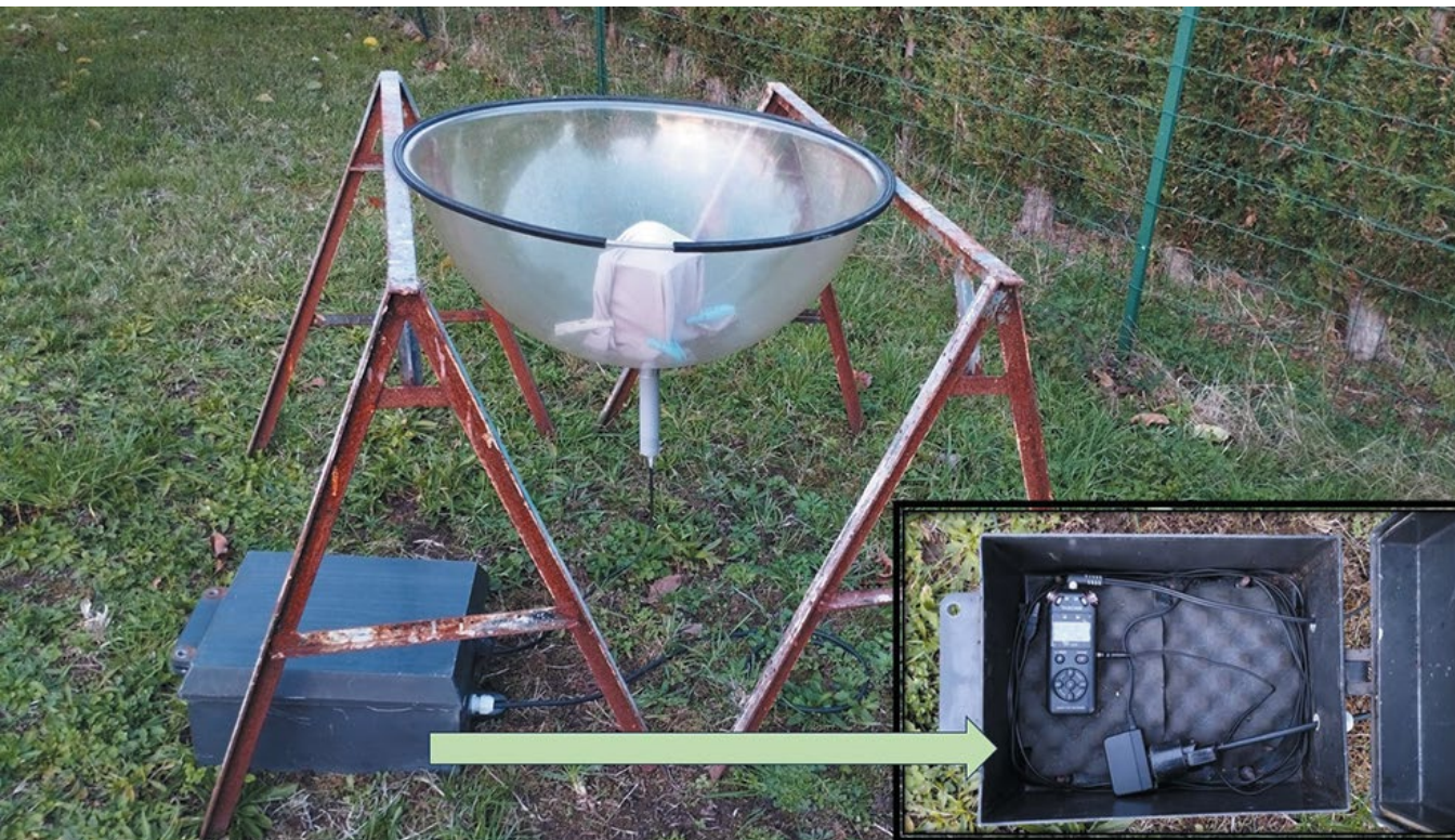
Photo 1 : Unité autonome d'enregistrement de C. Mercier, avec sa tête parabolique et l'intérieur de la boîte étanche © C. Mercier
