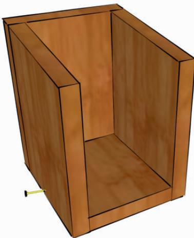
Placer le 2<sup>ème</sup> côté. 3 vis pour l'arrière et 1 pour le fond.
