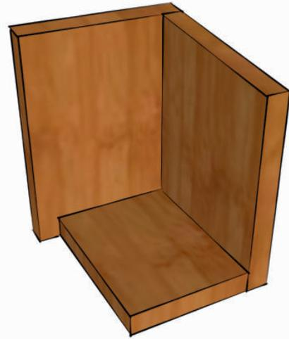
Pose du fond. Mettre une vis par côté.
