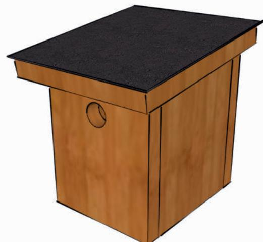
Éventuellement, pose d'une toile bitumée pour l'étanchéité.
