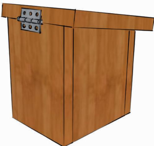
Pose du toit. Fixation avec une charnière à l'arrière.
