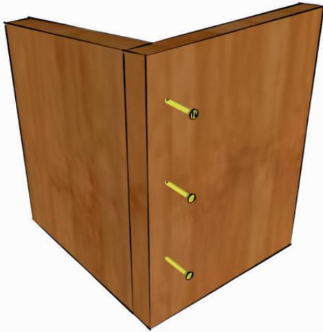
Assemblage de l'arrière et d'un côté avec 3 vis.
